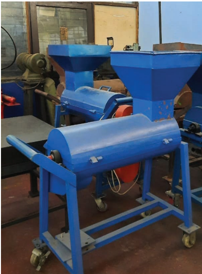
Mesin pencacah sampah yang dibuat oleh siswa Jurusan Permesinan SMKN 6 Bandung. (Ayobandung.com/M Naufal Hafizh)
